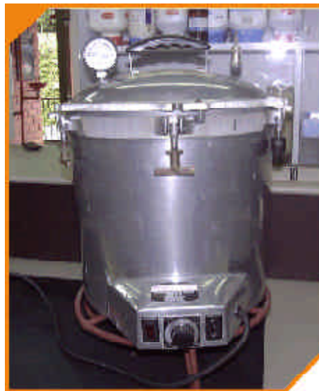
Figura 8 Autoclave pequeña para la producción de semilla de hongos.
