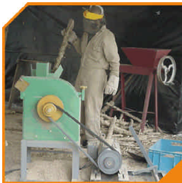
Figura 13 Desintegrador – Picador para residuos agrícolas.
