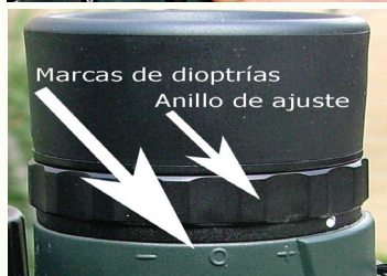
Foto 5. Con el anillo de ajuste de dioptrías podrás adecuar el binocular a tus requerimientos ópticos personales.
