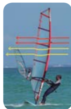
Figura 29.11. Gracias al principio de Bernoulli, el efecto del viento sobre la vela produce una diferencia de presión que "absorbe" al windsurf hacia la zona de baja presión a gran velocidad.
