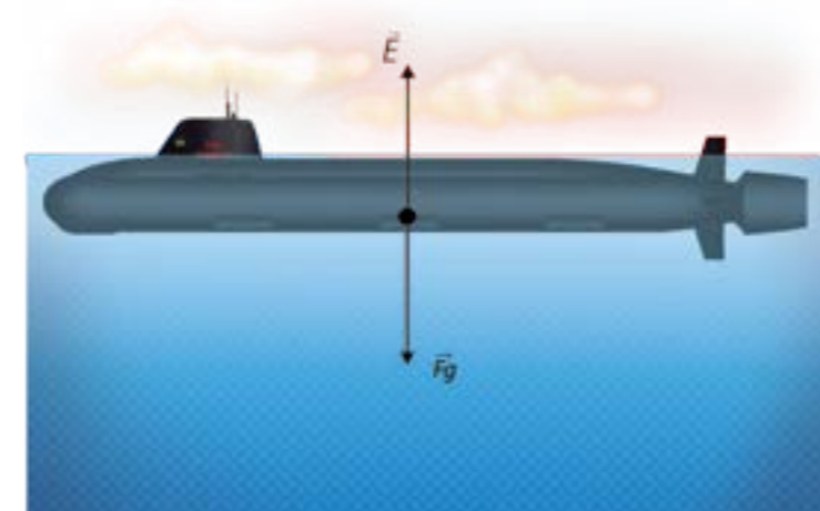
Figura 29.23. Si el objeto flota totalmente sumergido en un fluido, su peso es igual al empuje ascendente.
