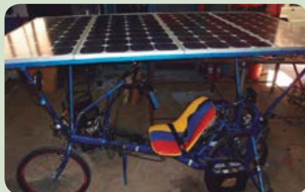
Figura 22.17. Un vehículo que usa energía solar y tracción humana, diseñado en la Unexpo.
