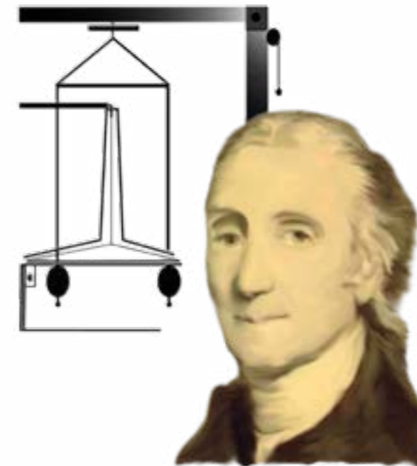
Figura 26.11. Balanza de torsión inventada por Cavendish y que sirvió para medir la constante de gravitación universal.
