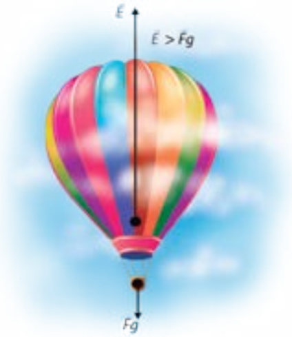
Figura 30.26. Un globo aerostático sube en la atmósfera gracias al empuje ascendente que recibe del fluido (aire).
