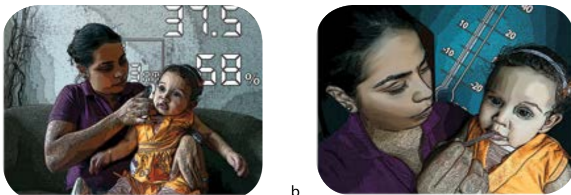
Figura 22.9. a) Medición de la temperatura con un termómetro digital, cuya propiedad termométrica es el voltaje. b) La propiedad termométrica del termómetro de mercurio es el volumen.
