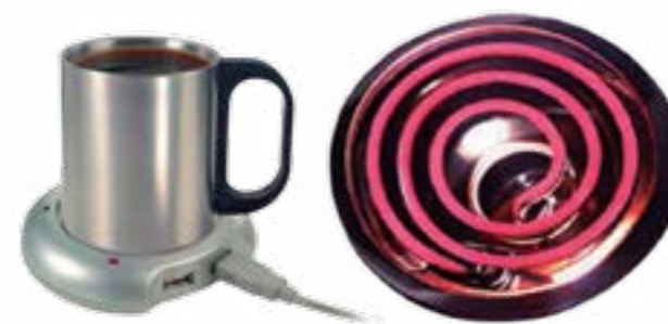
Figura 23.6. El dispositivo de la figura es un calentador de bebidas. Internamente, cuando la corriente eléctrica pasa por la resistencia arrollada en forma de espiral, en la base del dispositivo, ésta se calienta y transfiere energía al recipiente y al líquido que se desea calentar, aumentando su temperatura.
