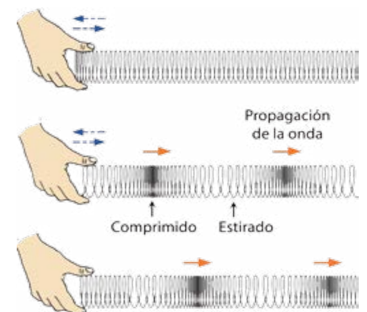
Figura 24.2. Ondas impulsivas que se propagan en un resorte bajo tensión.
