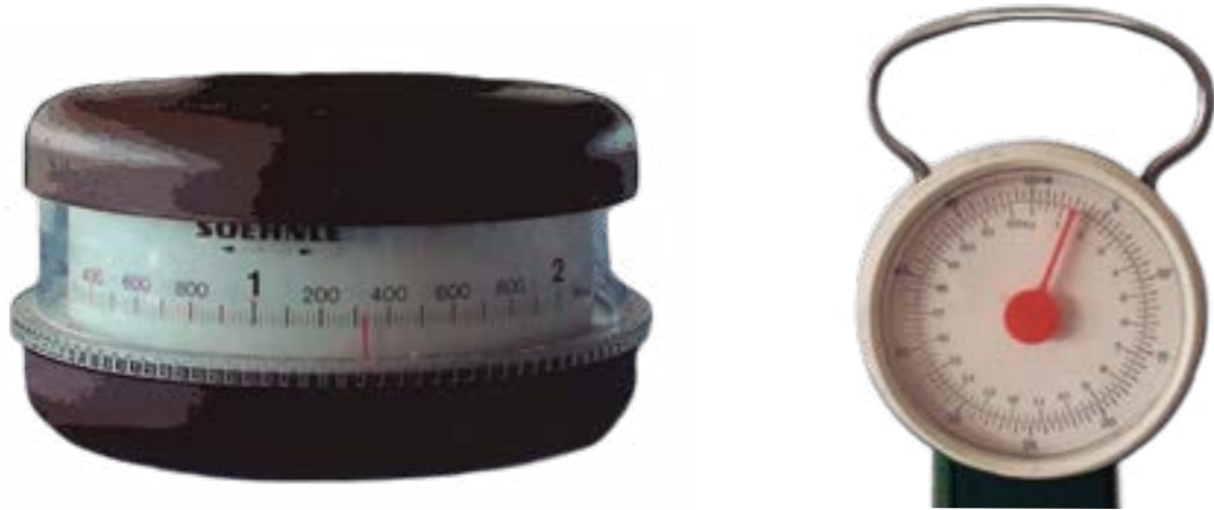
Figura 11.9. Se muestran dos balanzas: i) la A (izquierda) tiene una apreciación de 0,020 kg (20 g) y la B (derecha) tiene una apreciación de 0,250 kg (250 g). La balanza A es más precisa que la balanza B. ii) el rango de medida de la balanza A está entre 0 kg y 2 kg; y el rango de la balanza B está entre 0 kg y 22 kg.
