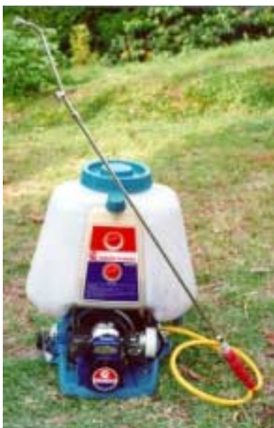
Figura 4. Equipo de aspersión motorizado de espalda con bomba de presión Maruyama MS-055S. (Detalle) Lanza de doble salida, adaptada a los equipos Maruyama MS-055S y Maruyama MS-253.
