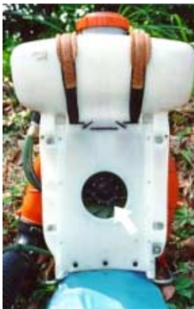
Figura 3. Bomba centrífuga adaptada al equipo Solo Port 423
