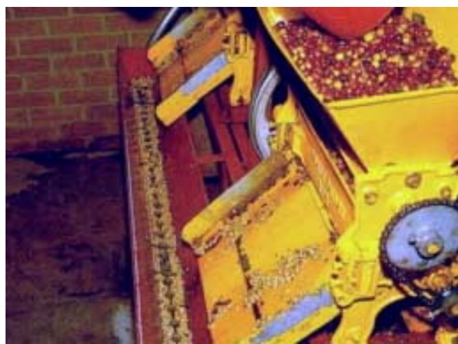
Figura 4. Sistema de transporte cable-disco instalado en la subestación de CENICAFÉ, Paraguaicito, Quindío.
