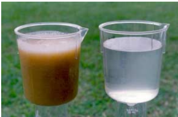
Figura 3. Apariencia del agua contaminada por residuos del proceso de beneficio húmedo del café (izquierda) y descontaminada por biodigestión anaeróbica (derecha).
