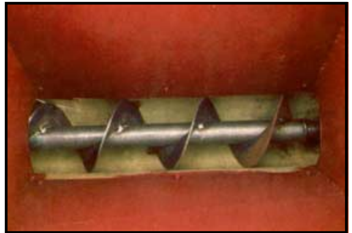
Figura 11. Sinfín en la base de una tolva recibidora
