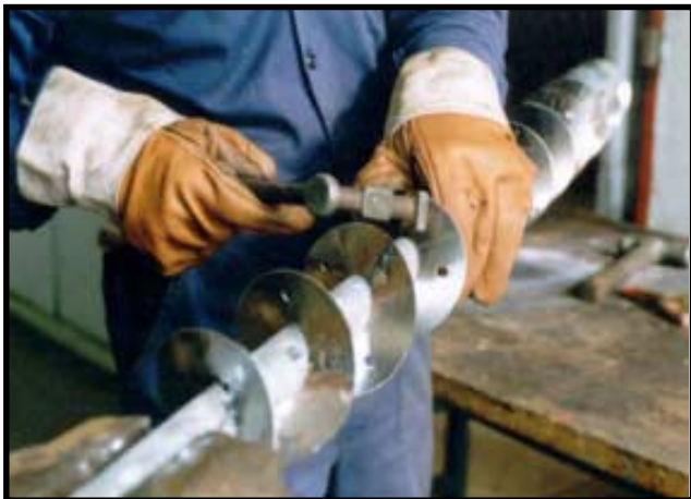
Figura 10. Calibración del paso y la perpendicularidad de los discos antes de ser soldados
