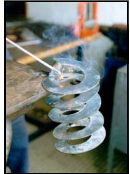
Figura 7. Unión de los discos con soldadura eléctrica
