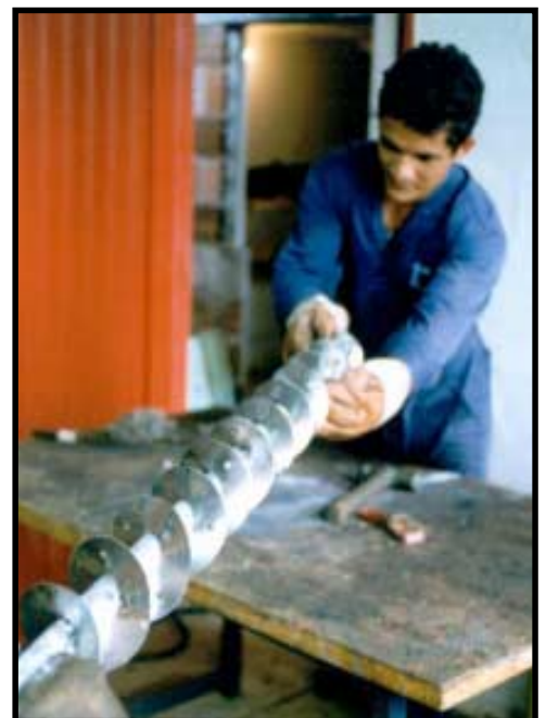
Figura 9. Discos estirados completamente sobre el eje
