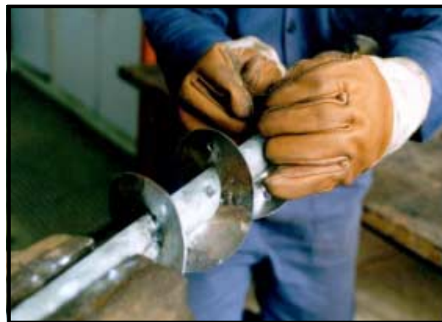
Figura 8. Estiramiento de los discos sobre el eje a manera de resorte helicoidal
