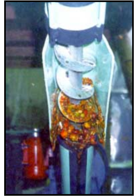
Figura 2. Descarga de pulpa mezclada con mucílago de café en un tornillo sinfín.
